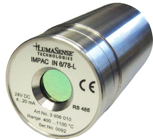
IN 6/78 是一款专为极薄玻璃表面非接触式温度测量设计的测温仪。其特殊的7.8 μm波长能够准确可靠地测量低于1mm厚度（超薄玻璃）的玻璃温度。正因为如此，其为全球超薄玻璃生产提供了全新的标准和解决方案。
